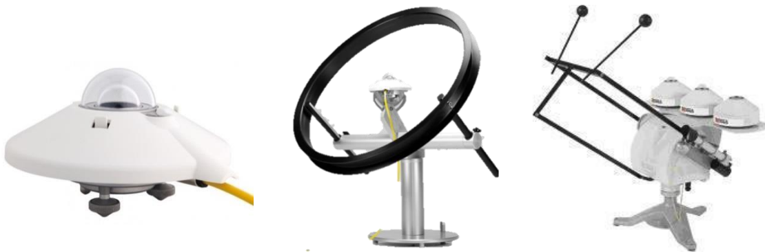
FIGURA 4: A) PIRANÓMETRO. B) PIRANÓMETRO CON BANDA DE SOMBRA. C) PIRANÓMETRO CON ESFERA
