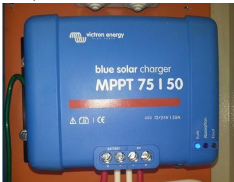
FIGURA 27: MODELO DE REGULADOR DE CARGA CON MPPT (R.VALDOVINOS)
